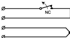
El MC 740-M14 es un contacto magnético universal que puede ser utilizado en sistemas de alarma y control de accesos, para proteger puertas y ventanas contra la apertura no autorizada.
