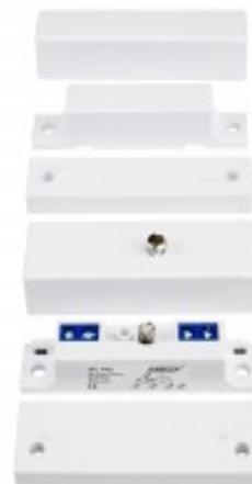
El MC 440 es un contacto magnético con función NC para montaje sobre una superficie que se puede utilizar tanto para sistemas de alarma como de paso con fines de vigilancia de, por ejemplo, puertas y ventanas, para evitar intrusiones. Con una mayor distancia entre imán y contactor y sistema antiapertura contra intrusos proporciona una seguridad excelente en la mayoría de instalaciones de alarma.
