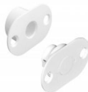
Adaptador de plástico con potente imán extra para la instalación de contactos magnéticos en puertas y ventanas de acero, o cuando se requiera una distancia de trabajo grande. Diseñado para los contactos MC 340, 346 y 347. El tapón se enrosca en el adaptador, lo que permite el ajuste de la distancia de trabajo.
