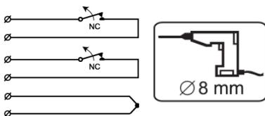
El MC 347 es un contacto magnético universal con doble función NC que puede ser utilizado en sistemas de alarma y control de accesos, para proteger puertas y ventanas contra la apertura no autorizada.
