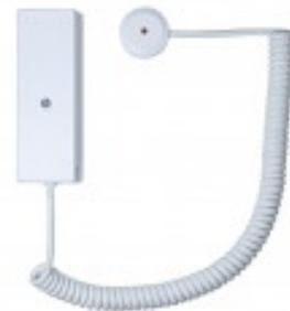
El GD 475-SJ tiene las mismas características que GD 475 con salida de transistor y se conecta al panel de control mediante la unidad de interfaz/ unidad analizadora IU 400. El detector tiene un cable en espiral con conector modular que se conecta a la caja de conexiones JB 103-4, lo que le permite desconectarse rápida y fácilmente del circuito detector, cuando por ejemplo se tienen que limpiar las ventanas.
