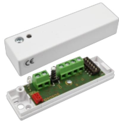
CD 470 ofrece una monitorización fiable contra ataques con herramientas mecánicas. El CD 470 es un detector inercial con 3 canales de detección separados: un canal de integración/canal de sierra para señales débiles con larga duración, un canal de conteo que detecta un fuerte impacto en la superficie monitoreada y un canal de ex-plosión que detecta señales muy fuertes, por ejemplo, una explosión.
