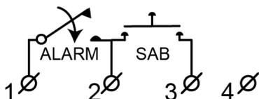
El MC 440 es un contacto magnético con función NC para montaje sobre una superficie que se puede utilizar tanto para sistemas de alarma como de paso con fines de vigilancia de, por ejemplo, puertas y ventanas, para evitar intrusiones. Con una mayor distancia entre imán y contactor y sistema antiapertura contra intrusos proporciona una seguridad excelente en la mayoría de instalaciones de alarma.
