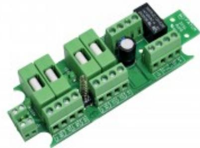
**Bloque de fusibles con tamper para distribución de corriente 8 A para 4 zonas.**
