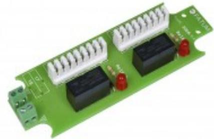
**Bloque de relé con 2 relés, 24 VCC. Diodo conectado en paralelo con bobina.**
