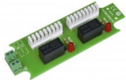
**Bloque de relé con 2 relés, 12 VCC. Diodo conectado en paralelo con bobina.**
