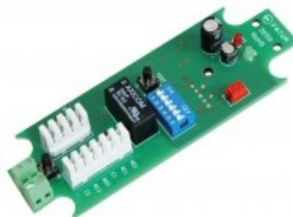
**Relé temporizador que facilita que un contacto magnético o detector de bajo voltaje controle la conexión o la desconexión de carga hasta 2A / 30V.**
