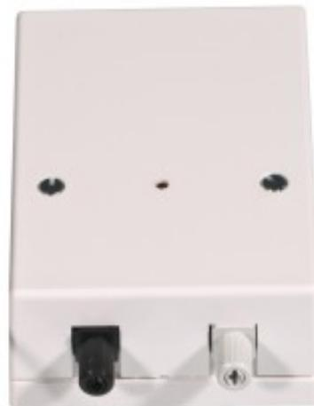
El sistema está compuesto por una unidad de control conectada a la fibra óptica. La unidad de control emite pulsaciones codificadas de luz a través de la fibra. La señal es recibida por la unidad de control y se compara con la enviada. Supervisa dispositivos conectados a la fibra a través de soportes especialmente diseñados. La unidad de control está conectada a un bucle de 24 horas y cualquier intento de hurto o de sabotaje de la fibra óptica hace saltar la alarma.
