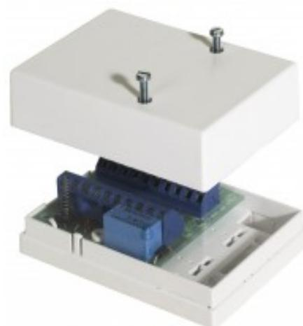
La RB 020 cuenta con dos relés y cada uno de ellos tiene una doble funcionalidad (2 x NC/NA). La conexión es a través de terminales de tornillos con protección de cable. Los relés activos se indican mediante LED. La tarjeta también tiene un interruptor de sabotaje.
