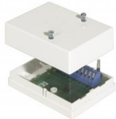
La RB 010 es una caja de relé con una doble funcionalidad (2 x NC/NA). La conexión es a través de terminales de tornillo con protección. Los relés activos se indican mediante LED. La tarjeta también tiene un interruptor de sabotaje.
