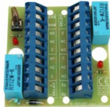
La RC 020 es una tarjeta con dos relés y cada uno de ellos tiene una doble funcionalidad (2 x NC/NA). La conexión es a través de terminales de tornillo con protección de cable. Los relés activos se indican mediante LED. La tarjeta también tiene un interruptor de sabotaje.
