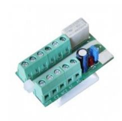
La RC 4 es una tarjeta de relé de muy pequeña y universal de alimentación DC y AC y doble funcionalidad (NC/NA) de 2A. La conexión del relé es mediante terminales de tornillo. La tarjeta tiene una entrada de alta resitencia para controlar el relé. Cuando la entrada de control esté conectada a (-) el relé se activará y se indica mediante el LED. La tarjeta está montada sobre una placa de plástico con cinta autoadhesiva.
