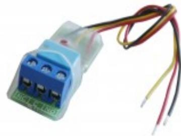
La RC 1 es una tarjeta de relé muy pequeña y universal con función NC/NA. La conexión del relé es mediante terminales de tornillo con protección de cable. El relé está controlado por un transistor que requiere poca corriente (1 mA). Cuando se activa el relé, se indica mediante el LED. En la parte posterior tiene cinta adhesiva que simplifica el montaje.
