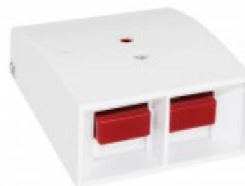
El HB 105-M es un pulsador mecánico que puede ser utilizado en diferentes aplicaciones en un sistema de alarma. El pulsador HB 105-M tiene dos botones con doble función (NC/NA). Se puede configurar para la activación por presión doble o separada. Tiene también una entrada para controlar el LED y protección mediante tamper contra la apertura indeseada.
