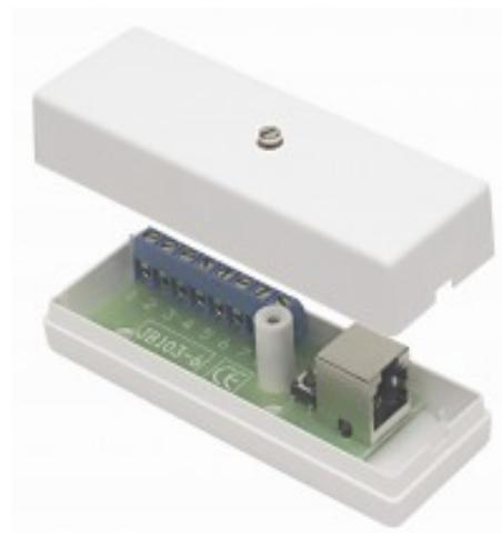
Caja de conexiones con 8 terminales de tornillo con protección de cable y un conector de 6/6 modular para la conexión de detectores de rotura de cristal GD 330-S y GD 370-S.
