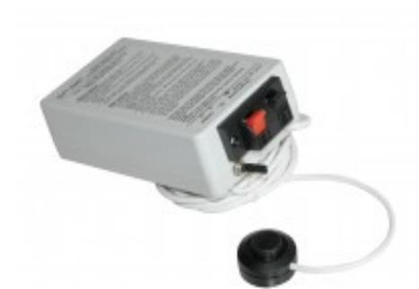
Dispositivo de prueba para detectores de rotura de cristal y detectores de vibración. Genera dos tipos de señales de prueba. Una señal para los detectores GD 300/GD 400 y otra para los detectores de la serie 400. Fácil de usar. No daña el objeto en el que se hace la prueba. También tiene una salida de 12 V.
