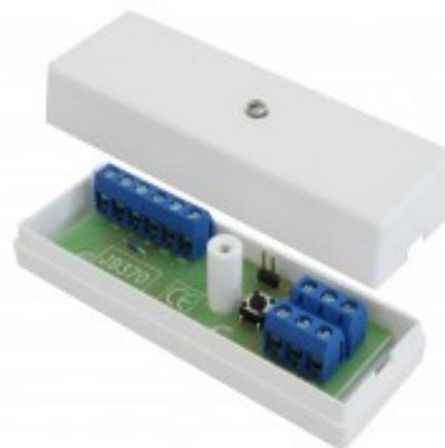
La JB 370 es una caja de conexión que facilita la instalación del detector de rotura de cristales GD 370. La caja de conexión interconecta IU 370 y/ o varias JB 370. La JB 370 tiene una resistencia ya incorporada para terminación del detector (con puente opcional) y sistema antivandálico.
