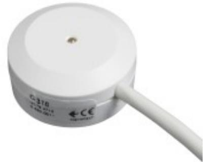
El GD 370 es un detector de rotura de cristal con salida de relé que se puede conectar directamente a la línea de entrada de cualquier panel de control. Está especialmente diseñado para proteger las ventanas de vidrio laminado contra la intrusión por medio de un corte de un agujero en el cristal.
