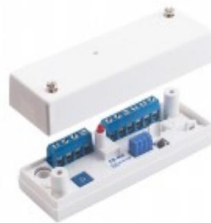
El detector de choque CD 400 ofrece una protección fiable para ventanas, puertas y paredes de material blando contra ataques de intrusión con herramientas empleadas con una fuerza considerable. Cuenta con un procesador de señal digital avanzado utilizando un micro-controlador con un algoritmo avanzado de detección. Esto significa que posee un excelente nivel de detección y una alta inmunidad a las perturbaciones ambientales.
