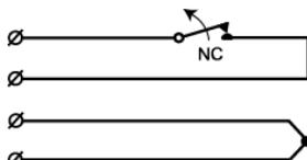
Der MC 740 ist ein sehr flacher, mit einem Öffnungskontakt (NC) versehener Aufbauöffnungsmelder, der für die Anwendung in Einbruchmelde- und Zutrittskontrollsystemen als Öffnungsüberwachung von Toren, Fenstern und Türen, geeignet ist. Beide Elemente des Melders sind in wasserdichten (IP67 Kunststoffgehäusen) eingebaut. Wegen seiner geringen Ausmaße ist dieser Melder auch für den Einbau zwischen Fenster und Jalousie geeignet.
