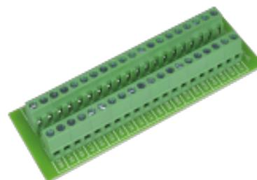
**Beschreibung****3032 ist eine Anschlussleiste zur Anwendung in Brandmeldeanlagen.**Der Klemmenblock verfügt über 20 Schraubklemmenpaare zur Verbindung der Brandmeldekabel mit einem Querschnitt bis zu 2,5 mm<sup>2</sup>.
